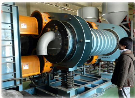
提案の根幹を成す省エネルギー型高衝撃乾式微粉碎機（タンデムリングミル®、左記写真）による木材微粉碎技術を実用化するために研究者を招聘し、特徴ある粉碎品の新規需要を開拓すると共に、地域木質資源の循環型利活用を促進するため、木材の効率的な集材法と川上から川下までのサプライチェーンの確立を目指します。
