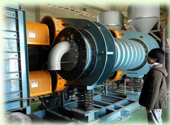
本事業の基盤技術であるタンデムリングミル型微粉碎機（左記写真）による木材微粉碎技術を実用化するために研究者を招聘し、特徴ある粉碎品の新規需要を開拓すると共に、地域木質資源の循環型利活用を促進するため、木材の効率的な集材法と川上から川下までのサプライチェーンの確立を目指します。
