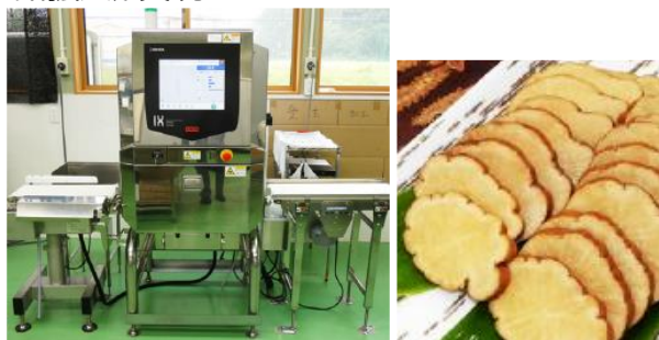
導入したX線装置。HACCP認証取得と生産性向上による事業拡大を目的として、検品作業工程への機械導入に補助事業を活用。
