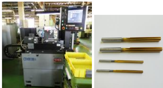
導入したNC円筒研削盤と被膜加工したハイスリーマの製品例。リーマの素材は「ハイス」「超硬合金」のいずれかが用いられる。
