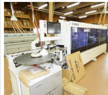
導入したエッジバンディングマシン(木工用縁貼り機)。機械化で対応可能な作業と高度技能者の手作業が必要な作業をバランスよく融合していく。
